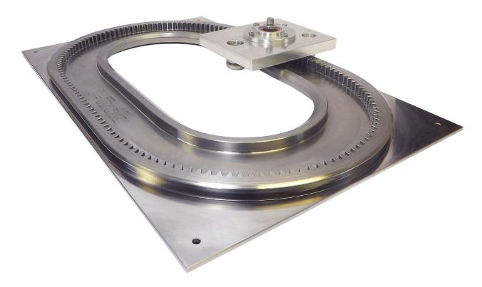
Die Getriebeverzahnung der Schiene ist präzisionsgefertigt und oberflächengehärtet, um eine überragende Festigkeit und Beständigkeit zu erzielen. In Verwendung mit einem gehärteten Ritzel und bei regelmäßiger Schmierung können hohe Antriebskräfte, minimales Spiel und Langlebigkeit erreicht werden.
