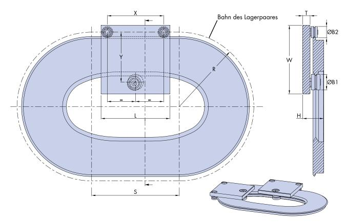
**Spezifikation der Schienen:** Die Informationen zur Laufwagenspezifikation von oben legen automatisch die Version des Schienenabschnitts fest.
