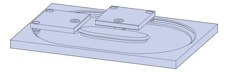
PRT2 1-Trak-Systeme können in einer Vielzahl an Größen gefertigt werden. Dabei können Lager in den Durchmessern Ø13, 18, 25, 34, 54, 64, 95, 120, 128 bis 150 mm verwendet werden. Es werden Lager aus den HepcoMotion PRT2 und HDS2-Produktreihen verwendet. Die Kapazitäten der einzelnen Lager sind auf Seite 8 dargestellt. Wir empfehlen unseren Kunden, die Tragfähigkeit der Systeme mit der Technikabteilung von Hepco zu besprechen.
