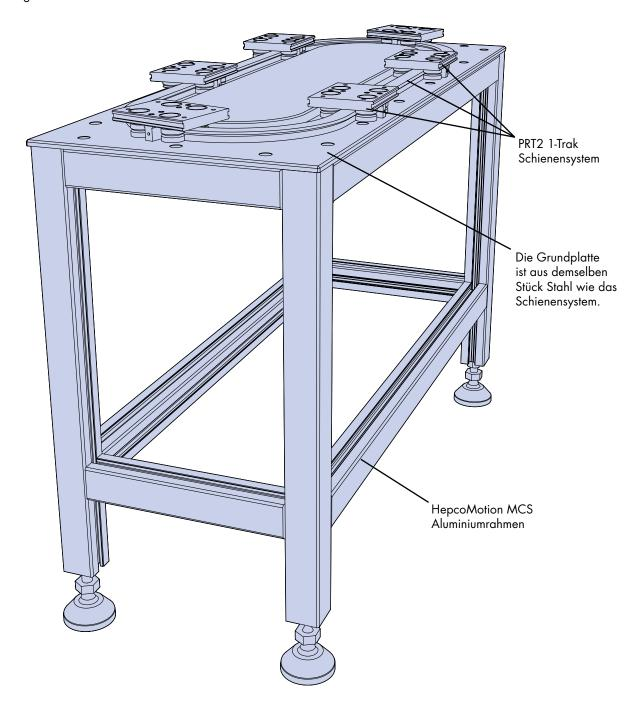
Die 1-Trak-Konstruktion bietet die Flexibilität, Kurven mit jedem beliebigen Radius und Schienen mit jeder beliebigen Breite zu wählen. Die Gesamtgröße des Systems ist auf ein Rechteck der Größe 5,5 m x 1m oder ein Quadrat der Größe 1,9 m begrenzt. Größere Schienensysteme können aus Einzelelementen zusammengesetzt werden.
