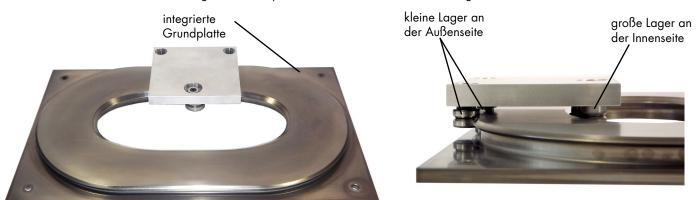
Eine weitere sinnvolle Einsatzmöglichkeit der PRT2 1-Trak-Version ist unten abgebildet. Bei diesem Aufbau ist der Laufwagen in ein Schienensystem eingepasst, das in einer Rinne verläuft. Die Schiene hat innen liegende V-Führungen, in die die Lager eingreifen. Der Vorteil dieser Konfiguration ist, dass die Kontaktpunkte zwischen den Lagern und den V-Führungen weit auseinander liegen, was dem System eine größere Momentenlast und Steifigkeit verleiht.
