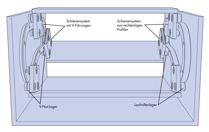
Herstellungsverfahren, Materialien und Größen sind für rechteckige Schienensysteme und Schienensysteme mit V-Führung gleich. Sie sollten als Satz spezifiziert werden, damit die rechteckigen Schienen und die Schienen mit V-Führung aufeinander abgestimmt werden. In den Sätzen sind die Durchmesser der Laufrollen und der V-Nut-Lager in der Regel gleich groß.
