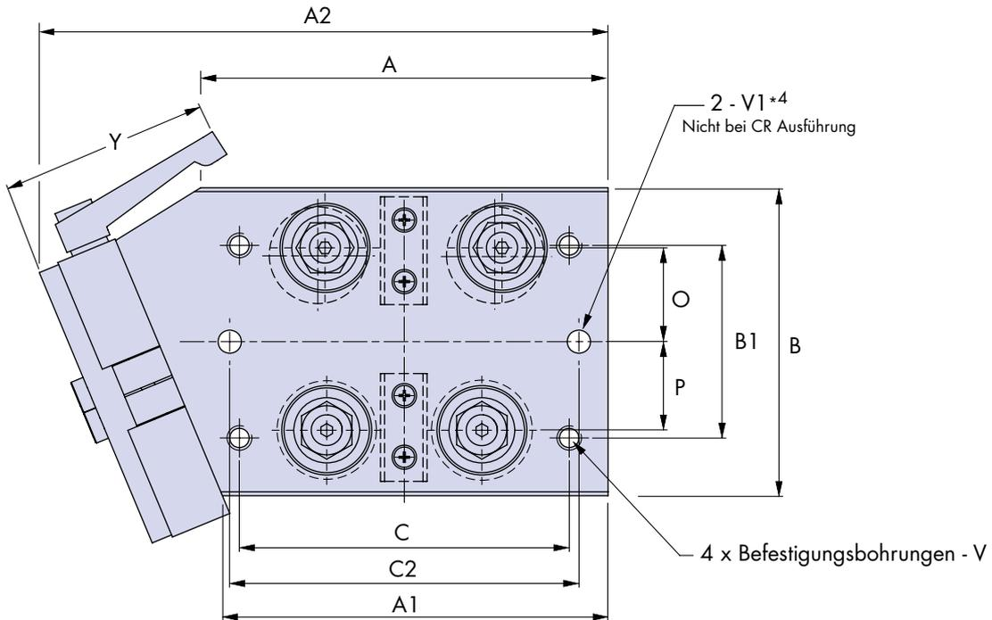
Die Ausführung mit linksseitiger Bremse ist auf Bestellung erhältlich. Abgesehen von der Position der Bremse sind das Gesamtlayout und die Maße jedoch identisch zur Version mit rechtsseitiger Bremse. Die Maße finden Sie in der Tabelle auf Seite 3 dieses Datenblatts.
