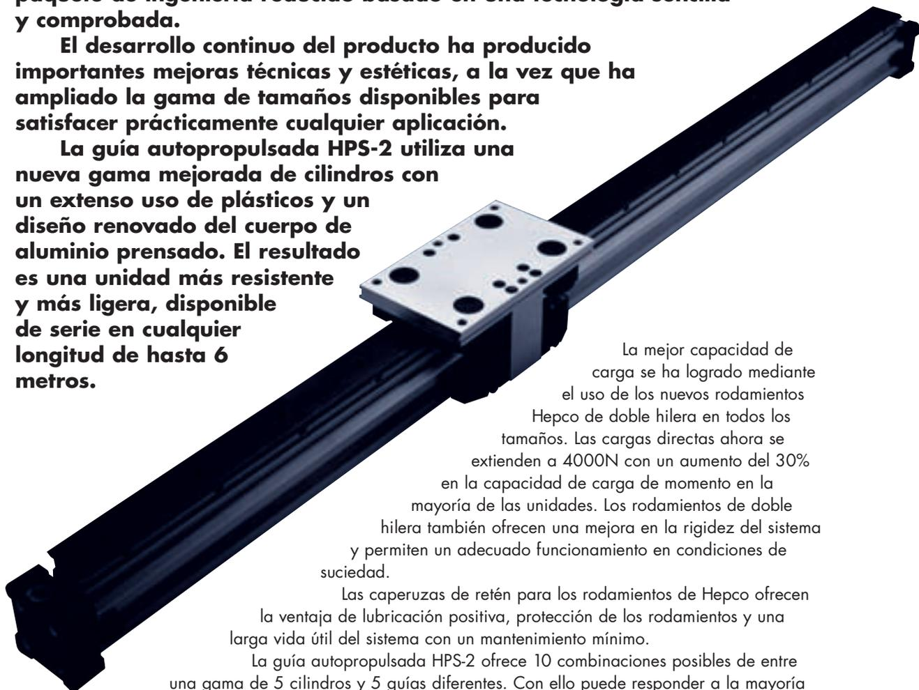
La mejor capacidad de carga se ha logrado mediante el uso de los nuevos rodamientos Hepco de doble hilera en todos los tamaños. Las cargas directas ahora se extienden a 4000N con un aumento del 30% en la capacidad de carga de momento en la mayoría de las unidades. Los rodamientos de doble hilera también ofrecen una mejora en la rigidez del sistema y permiten un adecuado funcionamiento en condiciones de suciedad.
