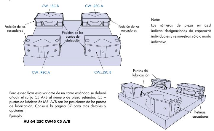
Los clientes que deseen la opción de lubricación centralizada para las caperuzas con las pletinas rascadores ensamblados también en los lados de la parte interna, pueden elegir los puntos de lubricación a los lados de la caperuza en las posiciones C/D, ya que las posiciones A/B de los extremos estarían obturados. Esta opción no está disponible en los tamaños de carros AU64 y AU95, ya que las posiciones C y D no son compatibles con las caperuzas de menor tamaño CW64 y CW95.
