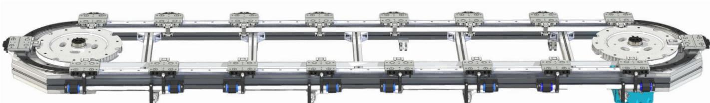
No existe un límite fundamental para el número de carros que pueden utilizarse en una configuración, pero las cargas aplicadas a la correa y a la conexión de la correa serán generalmente el factor que determine el tamaño del sistema más adecuado para una aplicación. La velocidad lineal y la tasa de aceleración afectarán a la carga sobre las conexiones de la correa y al par a través del conjunto de transmisión.
