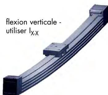
Dans l'équation 1 ci-dessus, E est le module de Young du matériau du corps en aluminium qui est égal à 68.000N/mm<sup>2</sup>. I est le moment d'inertie de la section (cf. tableau de la page 21). Le chiffre indiqué pour I<sub>x-x</sub> correspond à la flexion lorsque le corps est soumis à une flexion verticale et le chiffre indiqué pour I<sub>y-y</sub> correspond à la flexion lorsque le corps est soumis à une flexion horizontale - cf. figures à gauche et à droite de la page.
