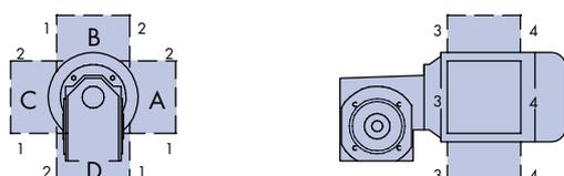
Le motoréducteur sera fixé sur l'unité DLS dans une de ces 8 positions. La boîte à bornes du moteur pourra prendre l'une des quatre positions, chacune de ces positions offrant 4 options de sortie de câble. Ces différentes options permettent au client de sélectionner la configuration idéale pour son application.
