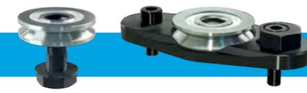
**Le galet pour trou borgne (BH)** permet l'installation sur un bâti de machine plein lorsqu'il n'est pas possible d'utiliser des trous traversant, ou si un réglage depuis le côté du rail est nécessaire. Il est disponible en **version concentrique (C)** fixe ou en **version excentrique (E)** réglable.
