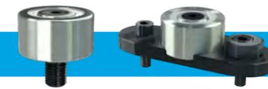
Les Galets de Came Larges HepcoMotion peuvent être utilisés pour rouler sur des rails plats Hepco, sur la face arrière des rails à talon à bord simple et pratiquement tous les types de surface de roulement. Ils se composent d'un roulement de haute capacité, à double rangée de billes à gorge profonde, avec une robuste bague externe au profil bombé.
