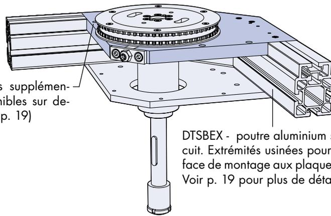
DTSBEX - poutre aluminium support du circuit. Extrémités usinées pour offrir une surface de montage aux plaques d'extrémités. Voir p. 19 pour plus de détails.
