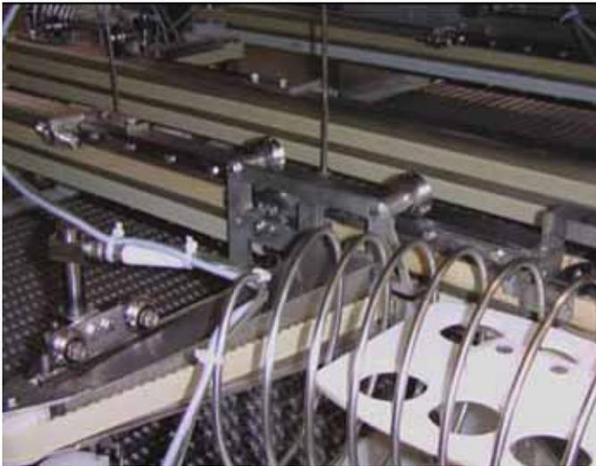
Les nouvelles roues DualVee<sup>®</sup> pour lavage sous pression de Bishop Wisecarver peuvent **diviser au moins par trois la fréquence de remplacement**, et sont, en cas de besoin, interchangeables avec les roues standard.
