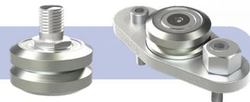
Les galets LTSS pour basse température sont lubrifiés à vie, avec de la graisse Aeroshell 22, qui est adaptée à des températures d'utilisation de  $-50^{\circ}\text{C}$  à  $+150^{\circ}\text{C}$ . Ce lubrifiant permet une utilisation à des températures plus faibles que le galet VACSS, permettant leur utilisation en chambres froides et équipements de congélation sèche.
