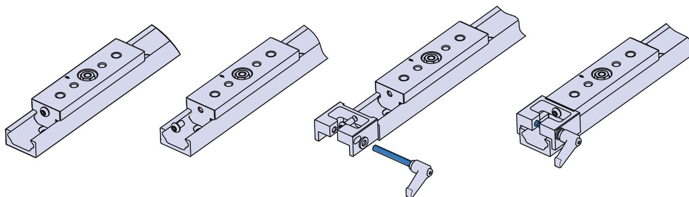
Le frein se monte à l'une ou l'autre extrémité du chariot UtiliTrak®, et comporte deux flancs situés de part et d'autre du rail UtiliTrak®. Le levier est monté sur un côté du corps du frein. Le frein s'actionne en tournant le levier dans le sens horaire ; le corps du frein serre alors le rail. Pour déplacer à nouveau le chariot, il suffit de desserrer le frein en tournant le levier dans le sens antihoraire de façon que les bras du frein ne soient plus en contact avec le rail.
