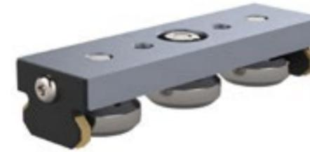
Utilitrak offre une fiabilité élevée pour un encombrement réduit. Il peut être monté sur une surface non usinée et tolère un important désalignement si deux rails sont montés en parallèle. Les options de matière et d'étanchéité offrent une réponse à la plus grande variété d'applications, y compris les environnements hostiles et les températures élevées.
